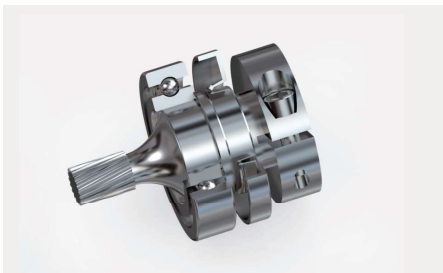
SUN GEAR와 입력축을 일체형으로 설계 회전진동 감소, 정밀도 확보
